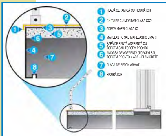
Detaliu: impermeabilizarea suprafeței unui balcon
